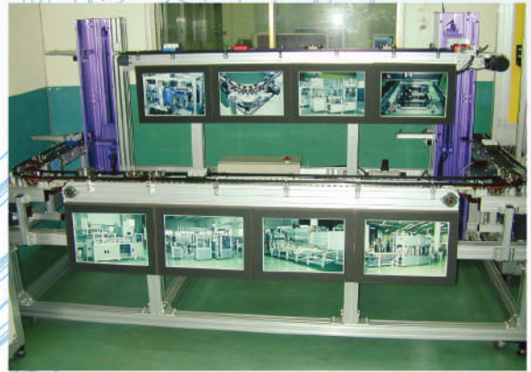
輸送循環系統 Automatic Transfer System
